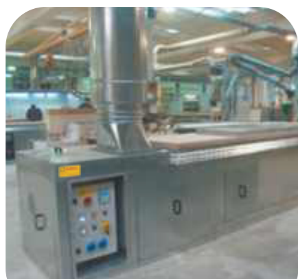
Αυτόνομος πάγκος τριβείου Sanding bench with aspiration unit
